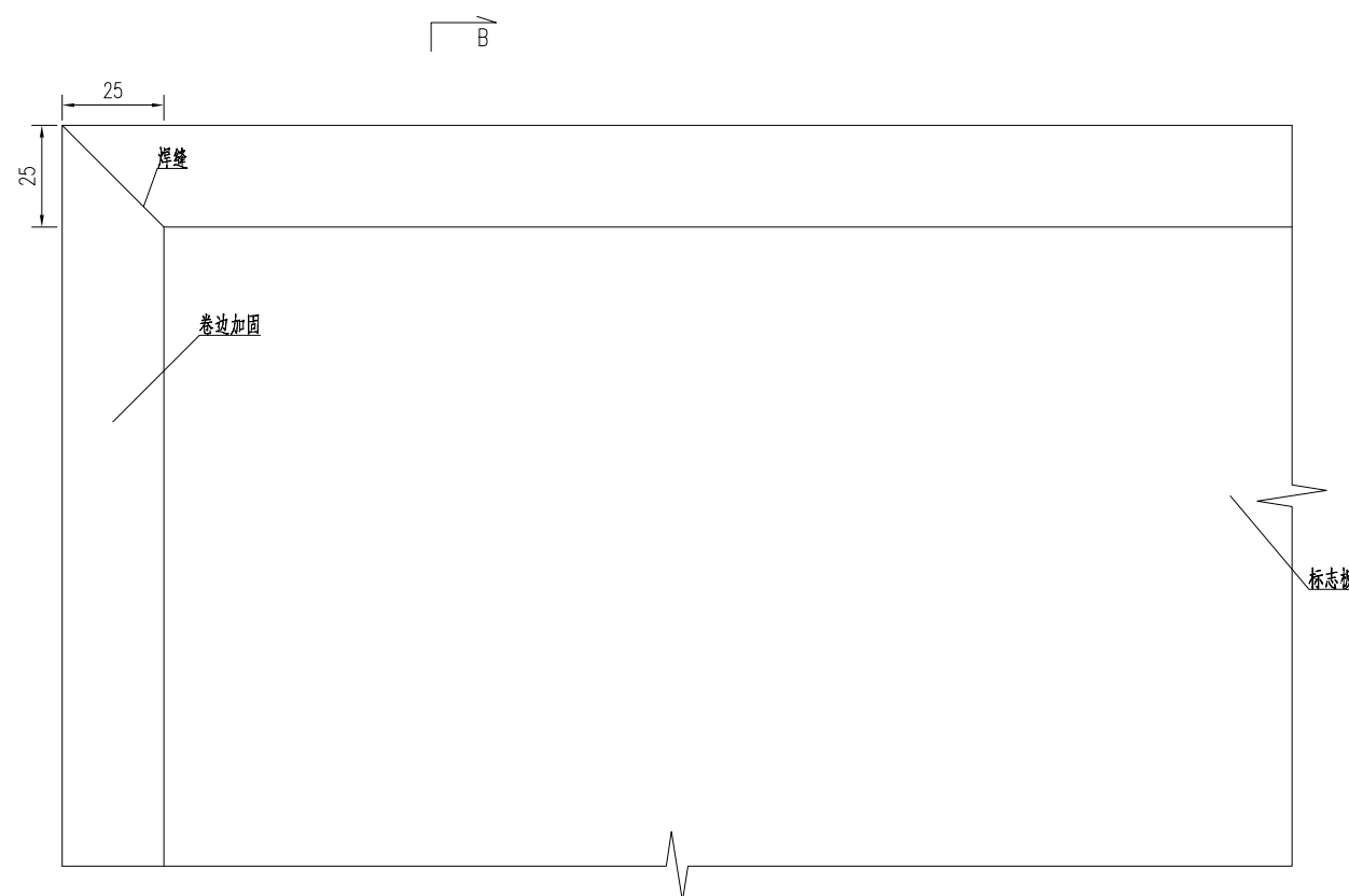
标志板边缘卷边加固大样图 1:2
