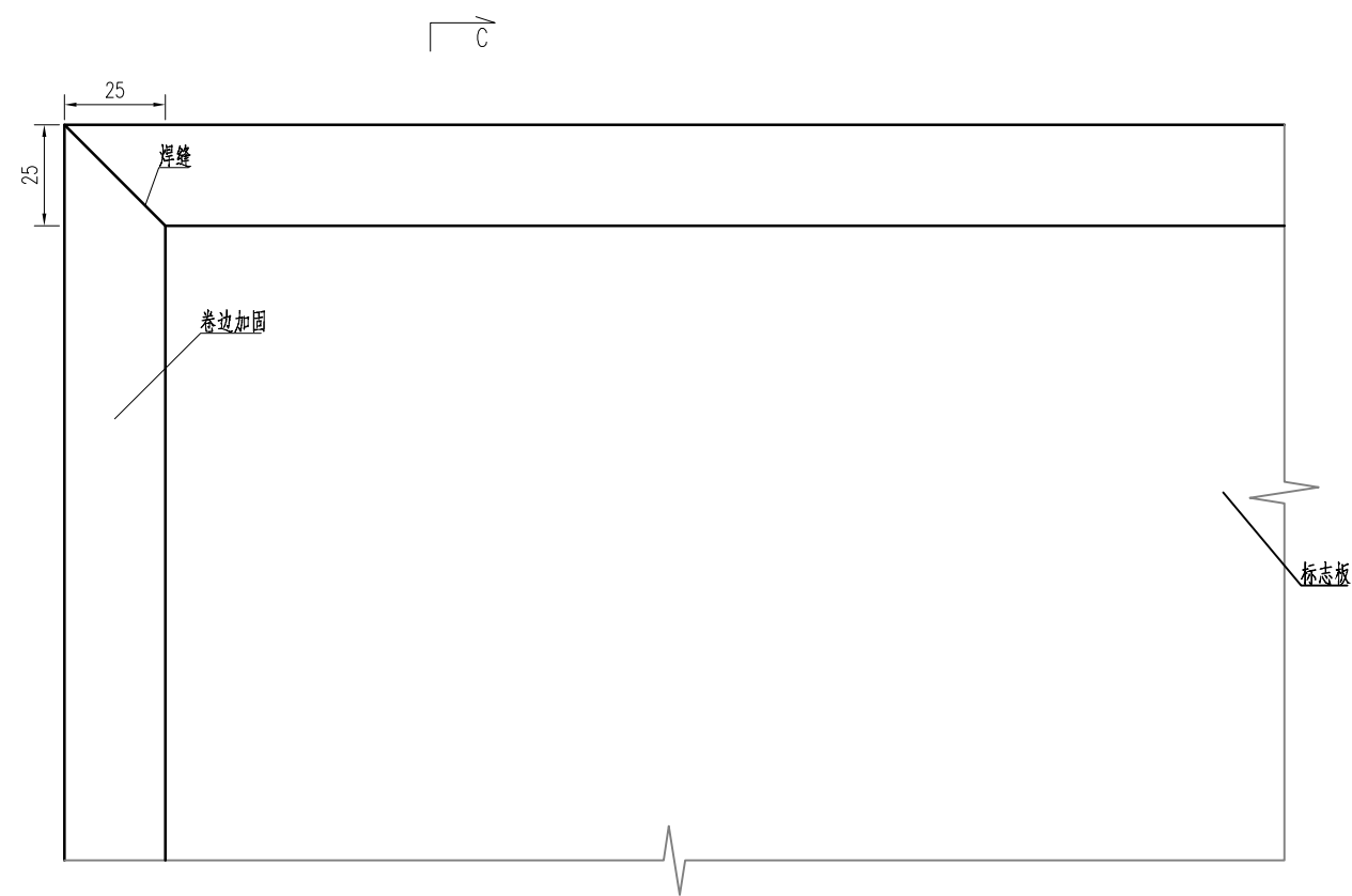
标志板边缘卷边加固大样图 1:2
