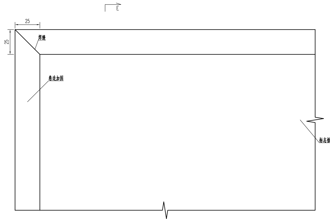
标志板边缘卷边加固大样图 1:2
